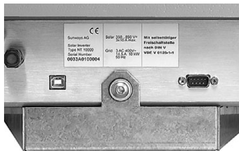
Fig.: connettore USB (sinistra) e connettore SUB D9 (destra) sul lato inferiore dell'apparecchio.
